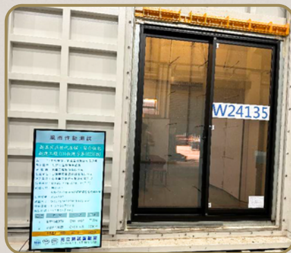
鋁窗風雨性能測試
